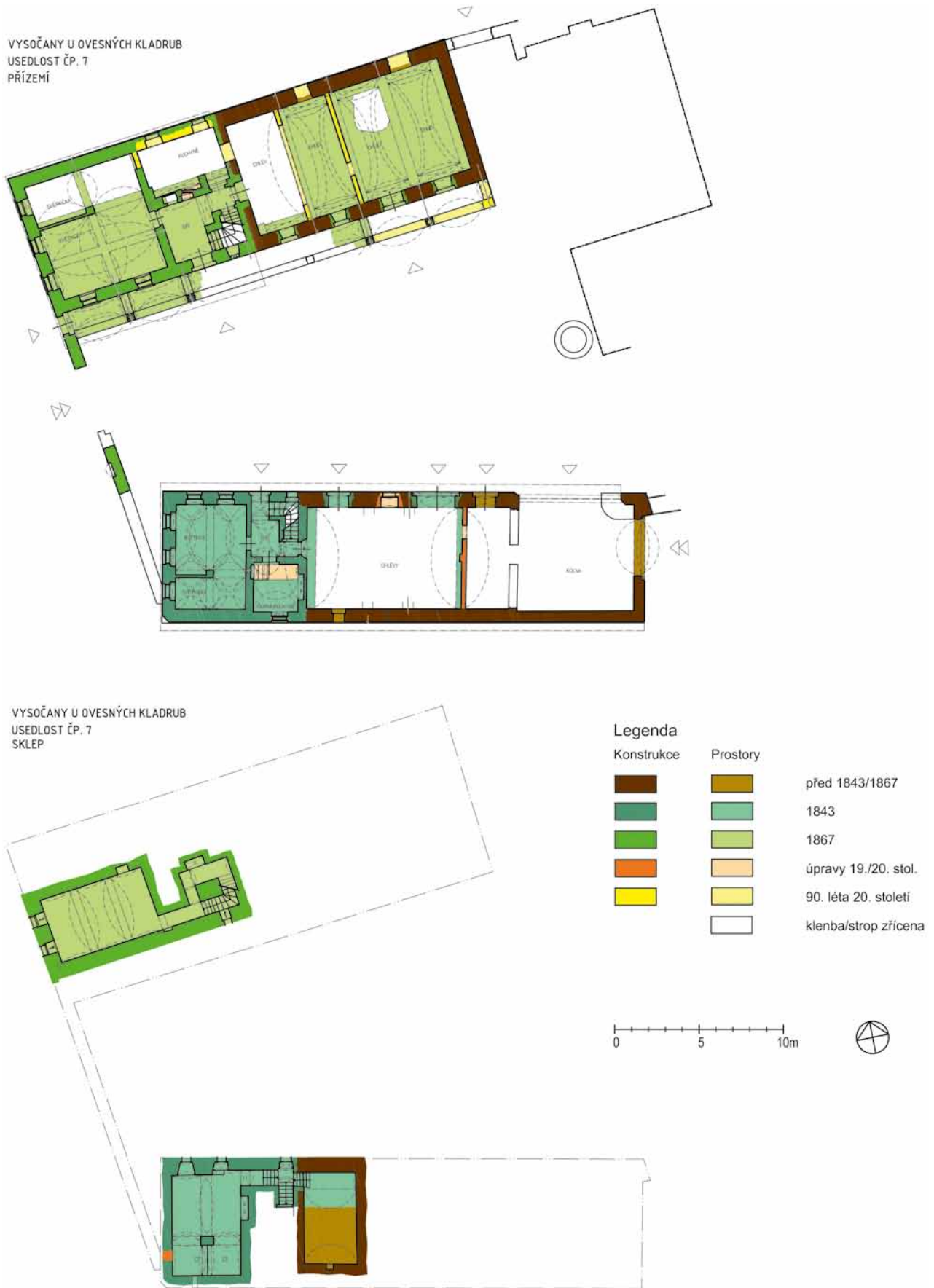
Obr. 7. Vysočany u Ovesných Kladrub, usedlost čp. 7. Zaměření půdorysu přízemí a sklepů, stavebněhistorická analýza. (Zpracovala K. Knotová, 2014; podklad Bečka - Pošta, SÚPPOP, 1988)
